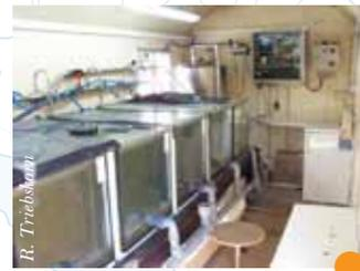
In den **Bypass-Systemen** wird Flusswasser per Rohrleitungen durch Aquarien gepumpt. Darin werden Bachforellen, Forelleneier und Flohkrebse unter kontrollierten Bedingungen in Schussen- und Argenwasser gehalten.
