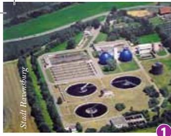
**Kläranlage Langwiese:** Die große Kläranlage des Abwasserzweckverbandes Mariatal, Ravensburg mit 184.000 Einwohnerwerten verfügt ab Anfang 2013 über eine weitergehende Reinigungsstufe mit pulverisierter Aktivkohle. Die Kohle bindet Spurenstoffe.
