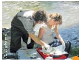
**Freilandprobstellen:** An fünf Stellen an Schussen und Argen werden Wassertemperatur, Sauerstoffgehalt und andere physikalische und chemische Parameter bestimmt. Außerdem werden Fische (Döbel und Schneider) sowie Wasser- und Sedimentproben für weitere Analysen entnommen.
